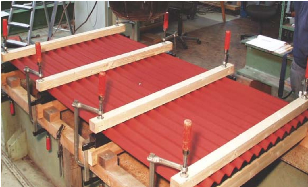
Bild 10: Versuchsaufbau für die Durchführung der Prüfung auf Stoßfestigkeit bei einer Stützweite von 620 mm
