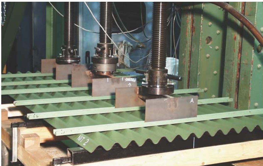
Bild 1: Versuchsaufbau für die Prüfung auf Durchbiegung unter Last an Bitumen-Wellplatten "Guttanit"
