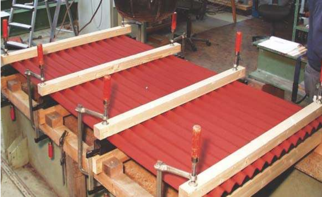
10. ábra: Kísérleti felépítés az ütésállósági vizsgálat elvégzéséhez 620 mm támszélességnél
