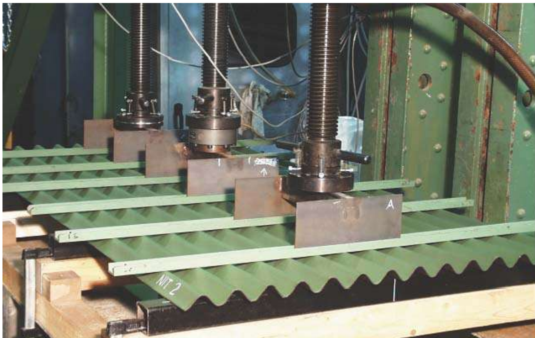
1. ábra: Kísérleti felépítés a "Guttanit" bitumen hullámlemez terhelés alatti lehajlásának vizsgálatrához
